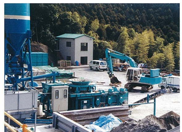
[建設汚泥処理工場で稼働中のケークルII ジュニア型]
