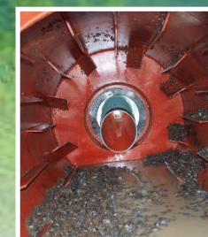
ドラムウォッシャー内部
