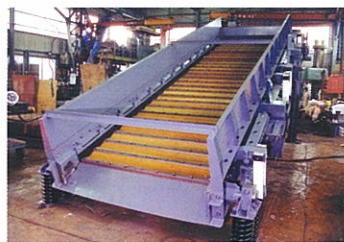
高含水率の原料も目詰まりせずに篩分 細粒土選別機『ハイテックスリーン』
