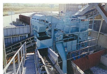
ゴミ混じりの砂利等からゴミを比重選別 砂利ゴミ除去装置『流選ハイジェット』
