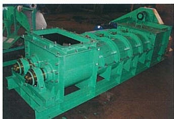
発生土等を均一にミキシング 混合装置『ミキシングスタビライザ』
